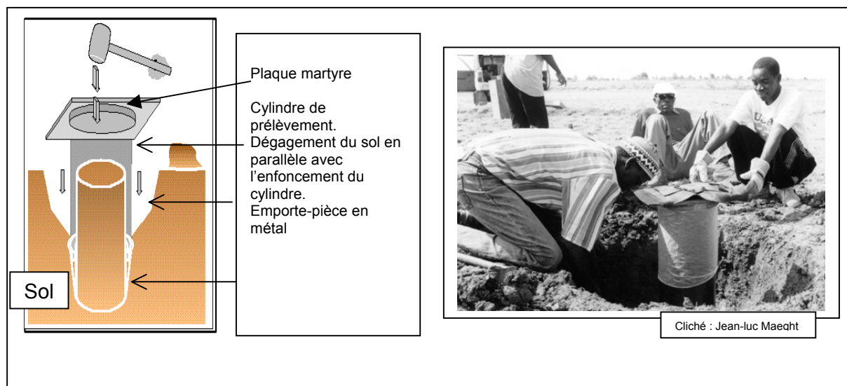
Figure1. Schéma de principe de prélèvement
