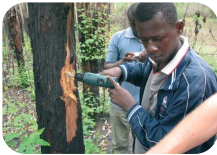
Prélèvement de copeaux pour des analyses des propriétés chimiques du bois d'eucalyptus.
